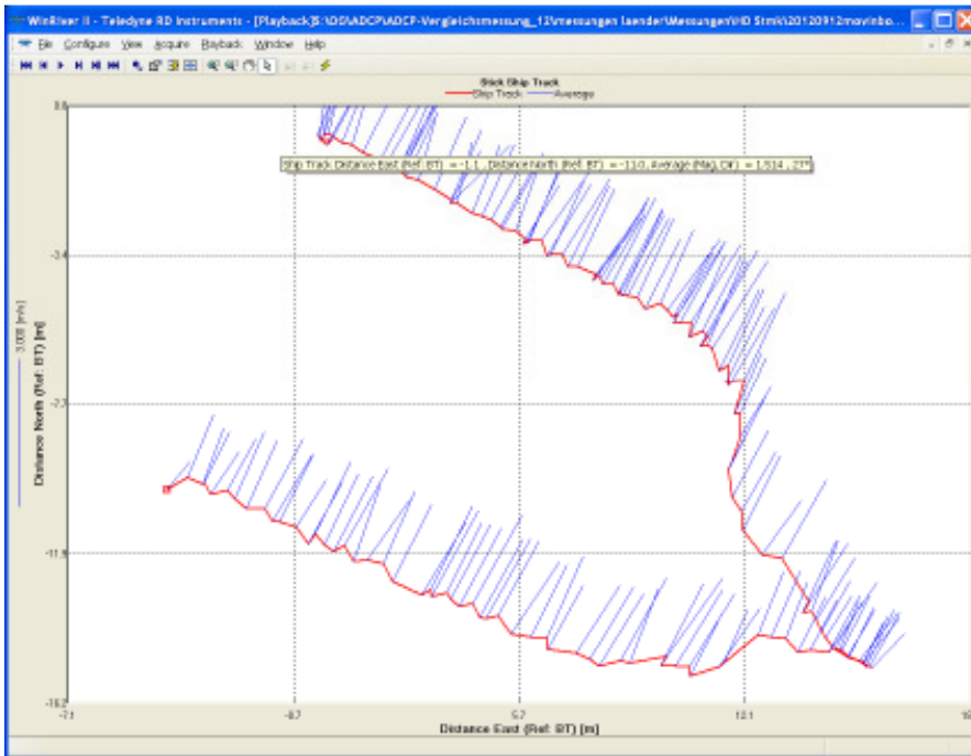
Abbildung 8: Überprüfung „bewegte Sohle“ durch eine Messfahrt (15:25 Uhr)
